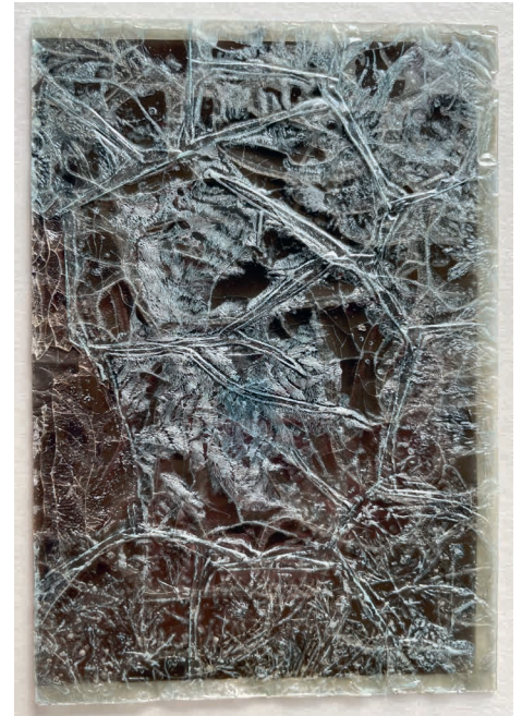
Celluloseacetatfilm: Essigsäuresyndrom Foto: Marjen Schmidt
