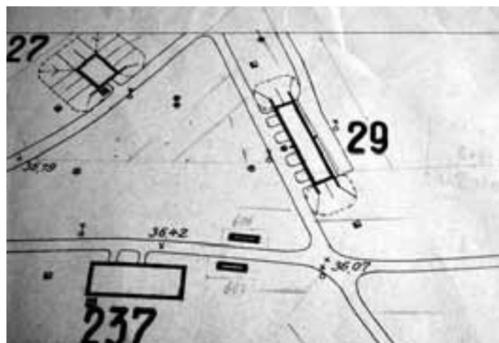
Bunker 29 im Werksgrundriss. An den Schmalseiten die üblichen Erdaufschüttungen. Ausschnitt aus dem Plansatz M 1:1000 von 1940.
